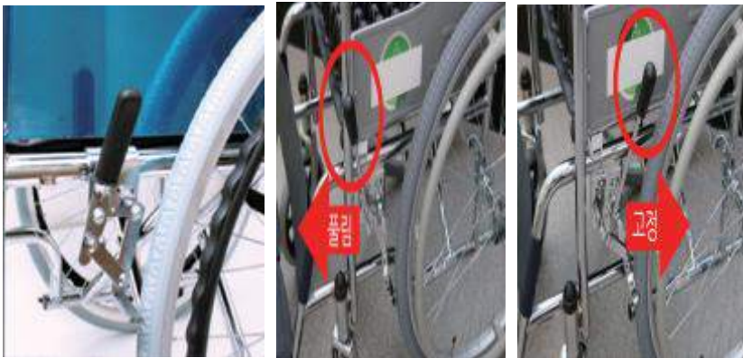
&lt;그림26&gt; 토글방식의 브레이크 - 풀렸을 때와 고정 했을 때
