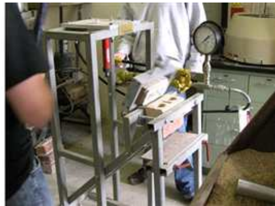
[해그림 6-2] 휨인장강도-Bond wrench test (ASTM C1072)
