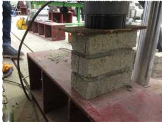
[해그림 6-1] 압축강도 및 탄성계수 (ASTM C1314)
