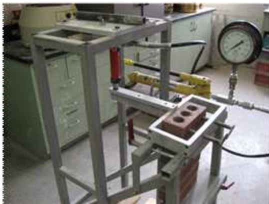
[해그림 6-2] 휨인장강도-Bond wrench test (ASTM C1072)
