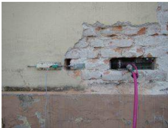
[해그림 6-5] 모르타르 수평줄눈 전단강도 현장시험 (ASTM C1531)
